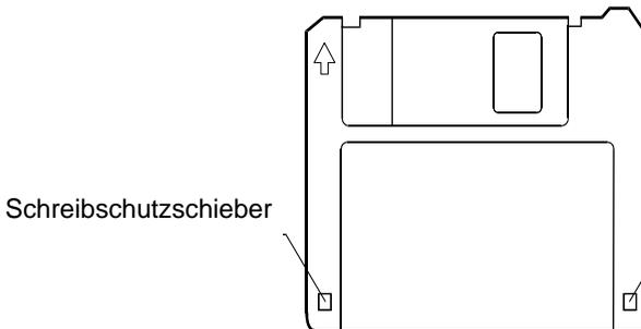
Das Diskettenlaufwerk ist ein 3,5-Zoll-Laufwerk mit hoher Speicherdichte, das 720-KB-Disketten mit doppelter Dichte (2DD) oder 1,44-MB-Disketten mit vierfacher Dichte (2HD) lesen und beschreiben kann.
